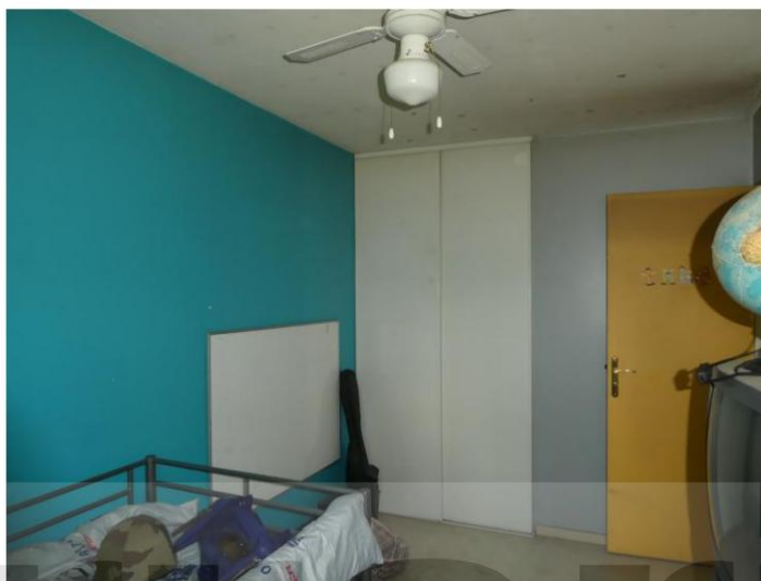
Le pan de mur de droite accueille un placard encastré ouvrant à deux portes coulissantes en bois mélaminé, fixées sur rails métalliques.
